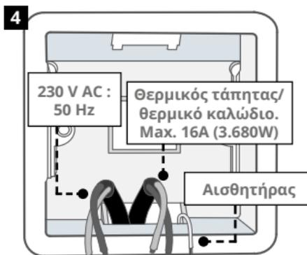
Εγκαταστήστε ένα χωνευτό κουτί διακλάδωσης, βάθους 50mm, στον τοίχο. Τραβήξτε τα καλώδια (θερμικό καλώδιο, τροφοδοσία και αισθητήρα δαπέδου) μέσα από το κουτί και ολοκληρώστε την καλωδίωση στους ακροδέκτες.
