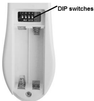
Fig. 10 Vano batterie telecomando
