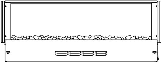
2.4 Hängen Sie die Frontglasscheibe ein und sichern Sie diese mit zwei ST4X10 Schrauben.
