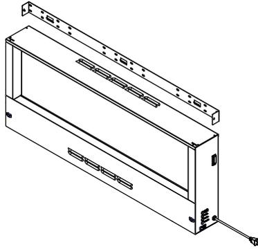
**2.2** Ανοίξτε τις τέσσερις σημειωμένες οπές με τη βοήθεια ενός τρυπανιού 8mm. Τοποθετήστε χτυπώντας τα ούπατ στις οπές. Εάν ο τοίχος είναι κατασκευασμένος από μασίφ ξύλο δεν είναι απαραίτητη η διάνοιξη οπών ή η χρήση πλαστικών ούπατ. Τώρα στερεώστε την επίτοιχη βάση με 8 βίδες (ST5x40).
