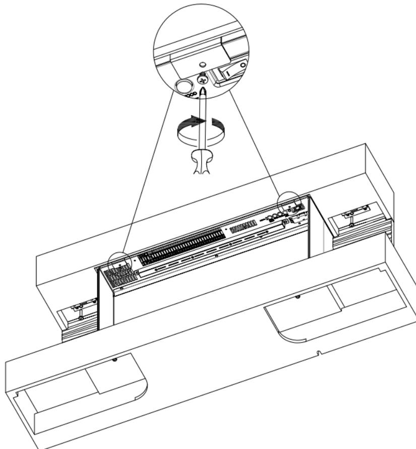
Verwenden Sie zwei ST4x8 Schrauben um die obere Kaminabdeckung am Gerät zu befestigen..
