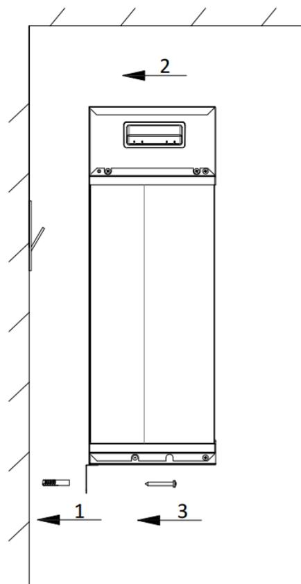
Bohren Sie das markierte Loch mithilfe eines 8mm Bohrer und setzen Sie den Dübel ein. Hängen Sie den Elektrokamin wieder an die Wandhalterung und befestigen Sie diesen mit einer Schraube ST5\*40 an der Wand.
