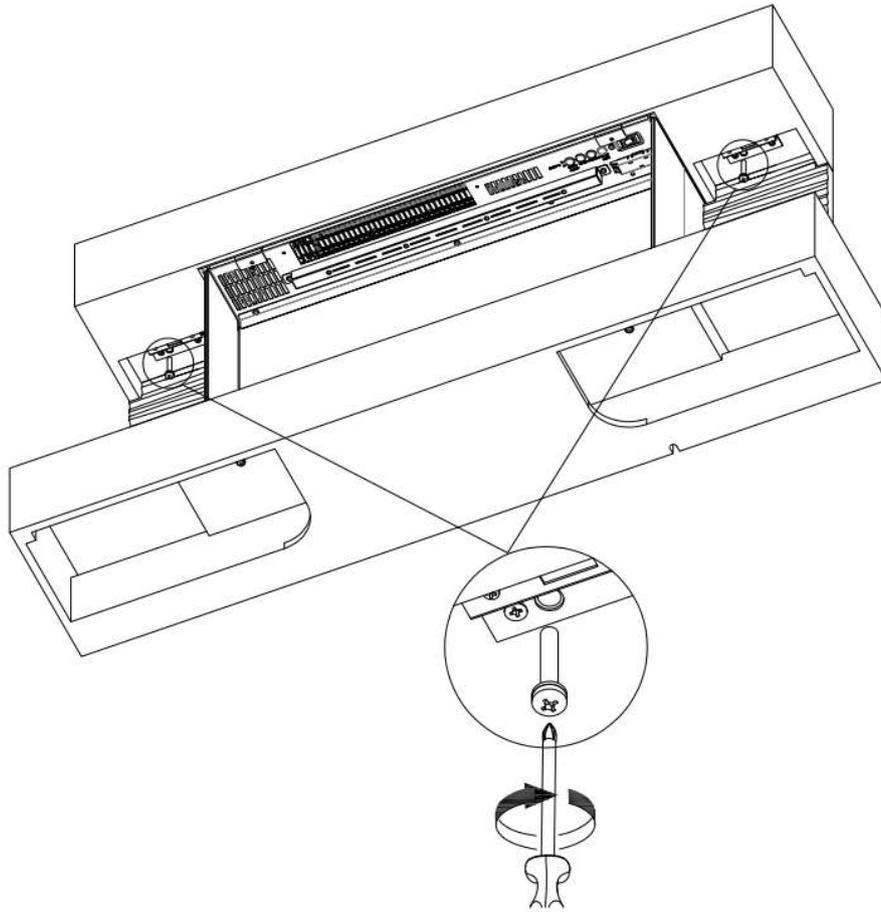
Verwenden Sie zwei M6x35 Schrauben und zwei Unterlegscheiben zur Befestigung der oberen Kaminabdeckung.
