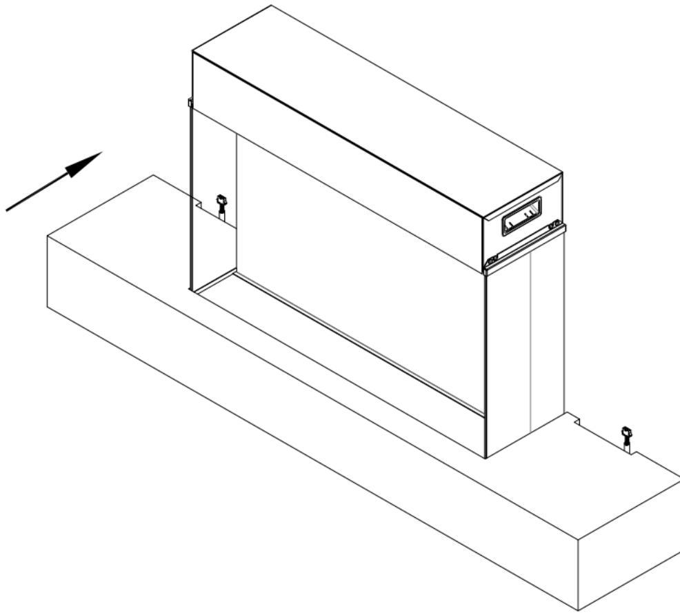
Nach Schritt 8 sollte die untere Kaminabdeckung bündig mit der Wand abschließen.
