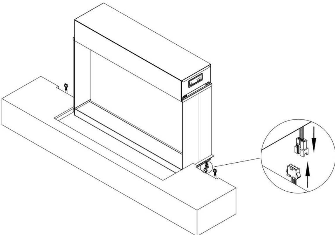
Verbinden Sie die Kabel für die LED Beleuchtung wie auf dem Foto angezeigt und verstauen Sie die Steckverbindung in der unteren Kaminabdeckung.
