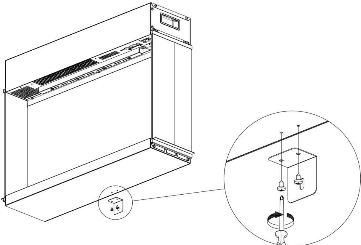
Befestigen Sie mithilfe der 2x ST4\*8 Schrauben die untere Befestigung am Gerät.
