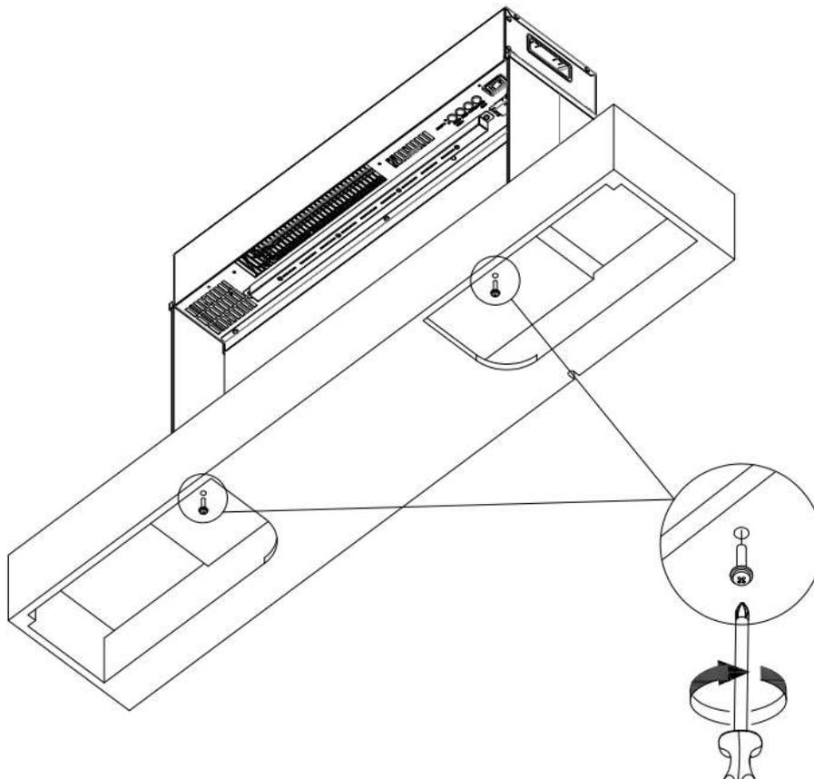
Verwenden Sie zwei M5x25 Schrauben und zwei Unterlegscheiben zur Befestigung an der unteren Kaminabdeckung.
