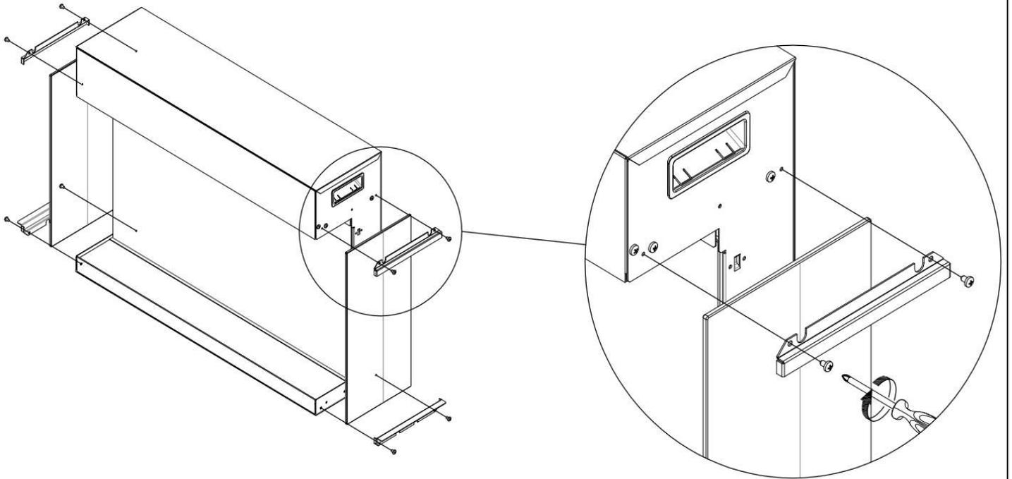
Verwenden Sie 8x ST4\*8 Schrauben, um das seitliche Dekoglas auf beiden Seiten mithilfe der oberen und unteren Glashalterung zu befestigen.
