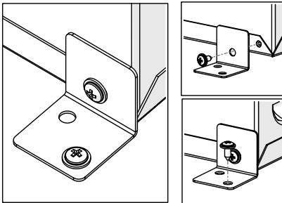
2b. Wenn Sie einen herkömmlichen Sims zur oder eine bereits bestehende Öffnung zur Installation nutzen, sichern Sie die Feuerkammer, indem Sie eine passende Schraube entweder durch das vordere oder hintere Loch auf der Innenseite der Feuerkammer einführen. Achten Sie dabei darauf, welche Stelle sich für die Installation besser eignet.
