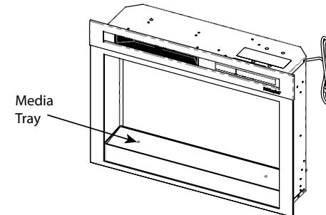
2a. Si le produit est installé dans un manteau Dimplex, s'assurer d'abord qu'il y a des orifices dans les panneaux latéraux près du haut, comme illustré ci-dessous. Si c'est le cas, aligner l'avant du foyer (sans la vitre) sur la façade du manteau. Introduire les vis fournies dans les orifices avant sur les faces intérieures du foyer. La vis va s'aligner sur l'orifice du manteau, ce qui va la maintenir en place.
