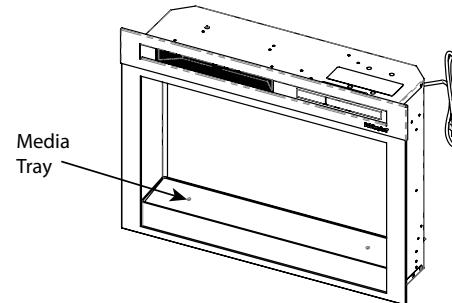
2a. Se l'installazione avviene in una struttura per caminetto Dimplex, verificare anzitutto la presenza dei fori nei pannelli laterali, vicino alla parte superiore, come indicato di seguito. In questo caso, allineare la parte anteriore del caminetto (senza il vetro anteriore installato) con la superficie anteriore della struttura. Installare le viti in dotazione nei fori anteriori sulle superfici interne del caminetto. Le viti si allineano con il foro della struttura, fissandolo in posizione.
